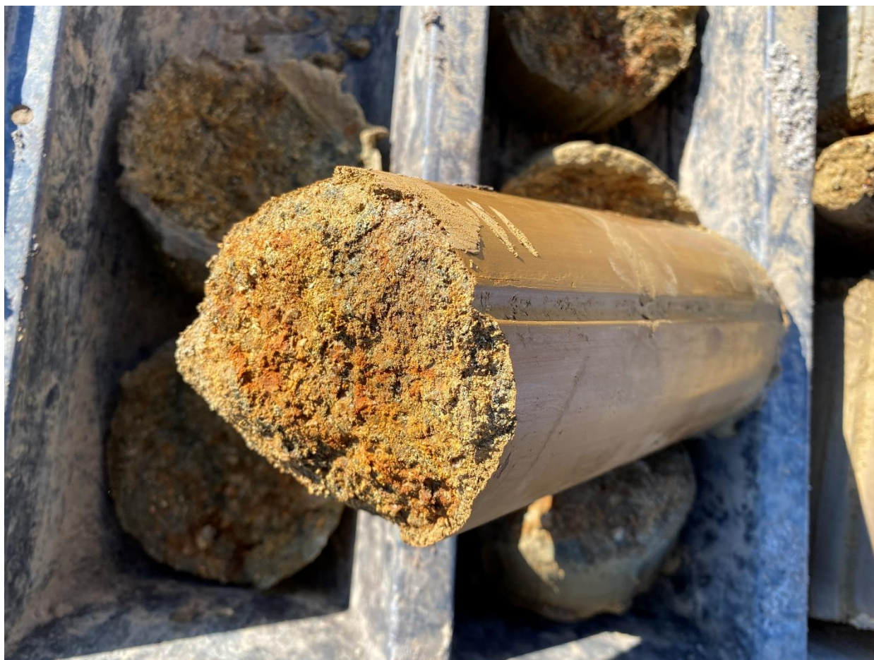
Silně zvětralé až eluviální polohy granitu, jádro, sonda JV1
